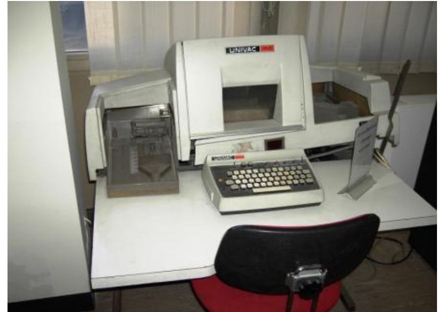
Macchina perforatrice a 80 colonne Univac 1710
