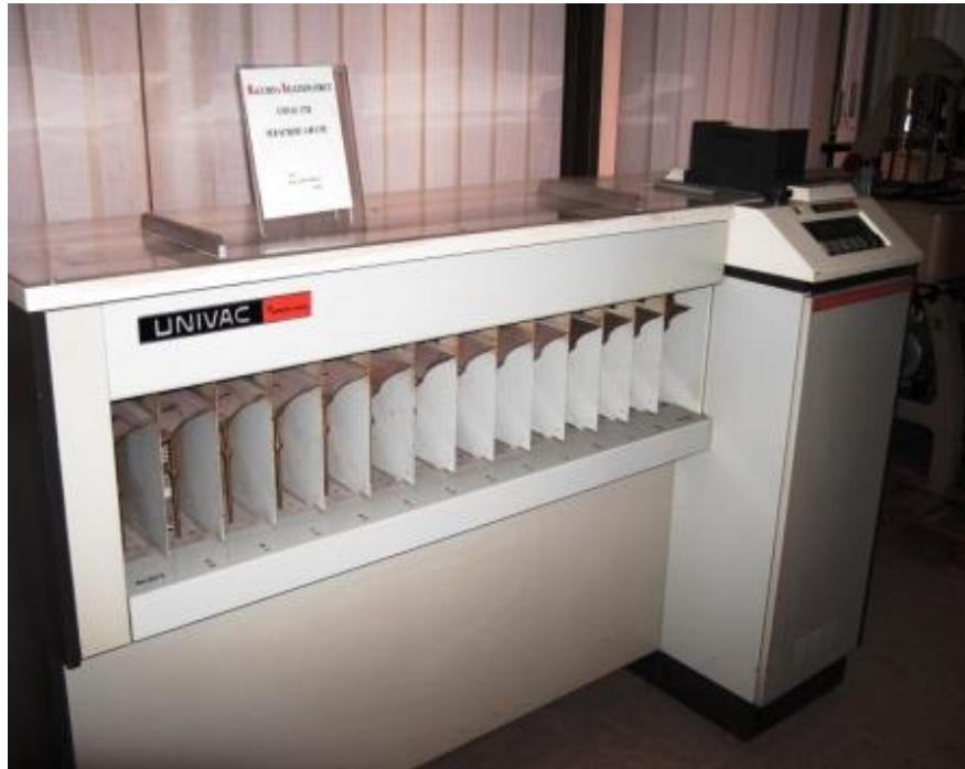
Macchina Selezionatrice Schede a 80 colonne Univac 1720
